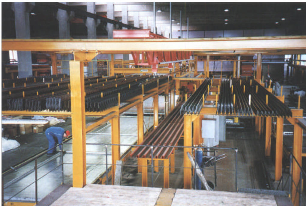
Gitterträger-Aktivlager mit 23 Stellen. Die Positionen der Trägerpakete sind frei wählbar und können millimetergenau programmiert werden. Das Aktivlager ist gleichzeitig die Stahlbühne der Anlage.
