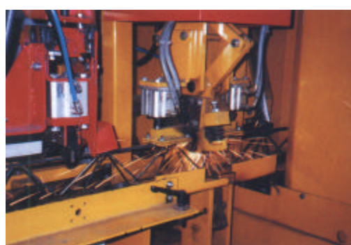
Überlappende Schweißung der Gitterträger-Obergurte. Restträger und neuer Gitterträger werden seitlich versetzt ineinander geschoben und überlappend verschweißt.
